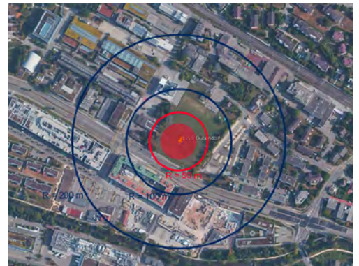
Empa Dübendorf: Risikoanalyse für das Hochtemperatur-Erdsondenfeld
