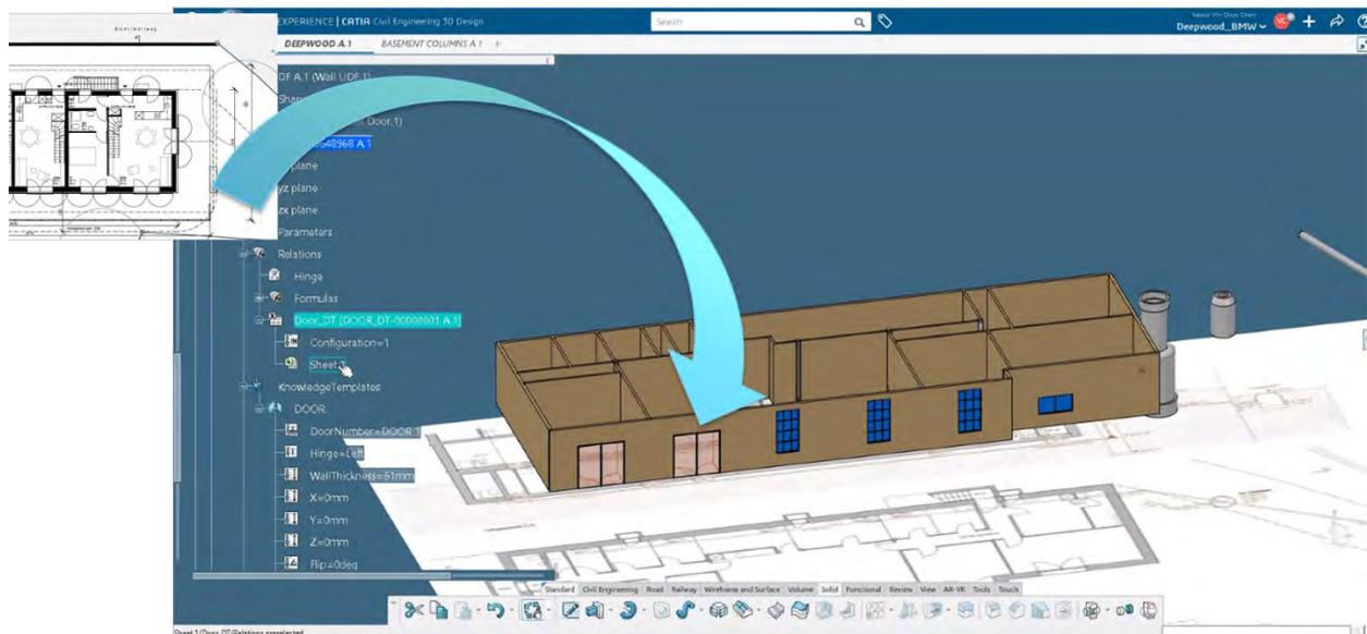
Abbildung 37: Aufbau des Modelles in Catia basierend auf den Baueinreichplänen
