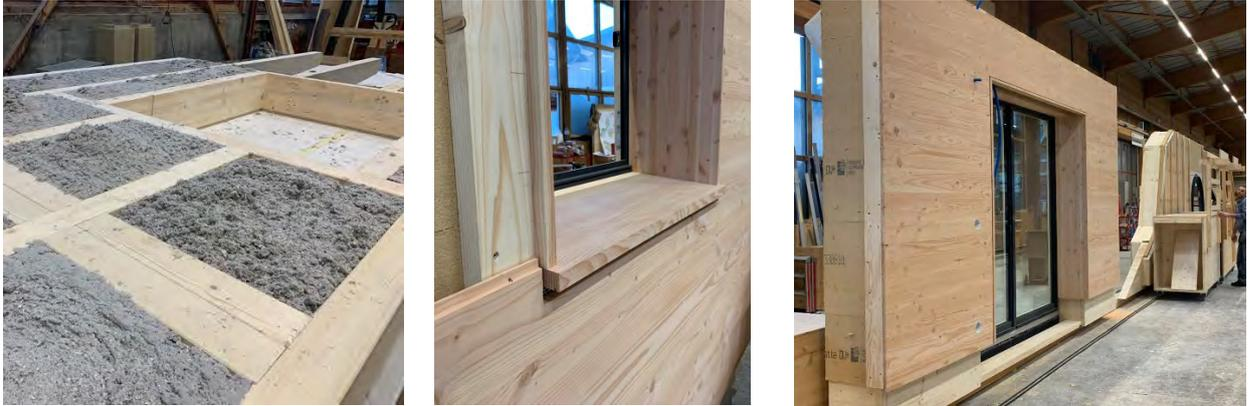
Abbildungsreihe 41: Produktion der Wandelemente bei Stuberholz.
